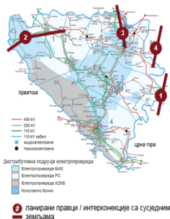
Слика 2. Приказ тренутног стања и планираних интерконективних водова електропреносне мреже са сусједним земљама
